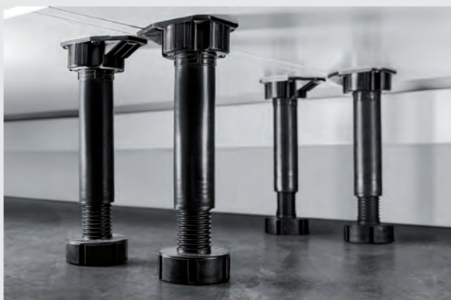
Nóżki 10 lub 15 cm wyposażone w piąty punkt podparcia, który zapewni dodatkową podporę boków szafek dolnych. Regulacja wysokości +/- 2,5 cm.
